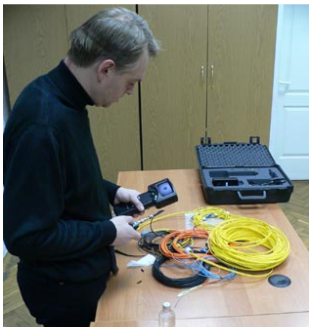
Контроль качества разъёмов ОВ.
